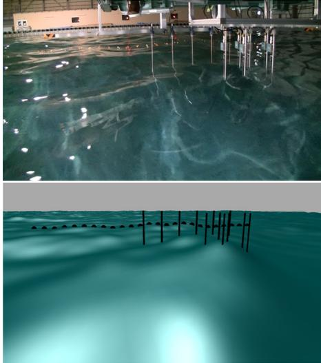
Figure 16. SPATIAL WAVE FORM AT THE INSTANCE OF FREAK WAVE OCCURRENCE FROM THE PICTURE OF EXPERIMENTS (TOP) AND FROM THE HOSM SIMULATION (BOTTOM).
