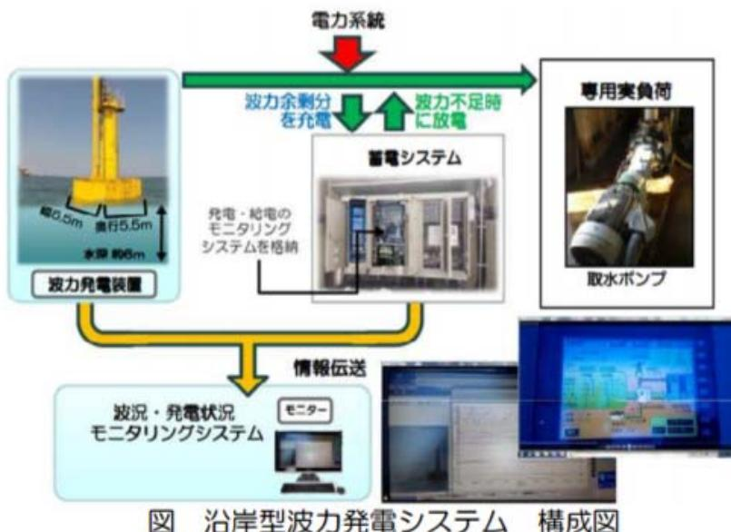
図 沿岸型波力発電システム 構成図
